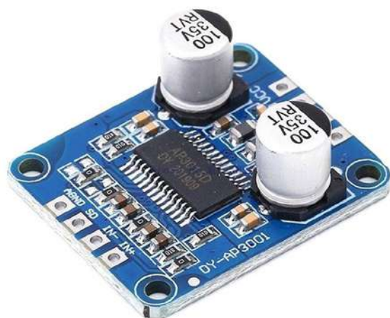
AMPLIFICADOR DE AUDIO DY-AP3001 30 WATTS
