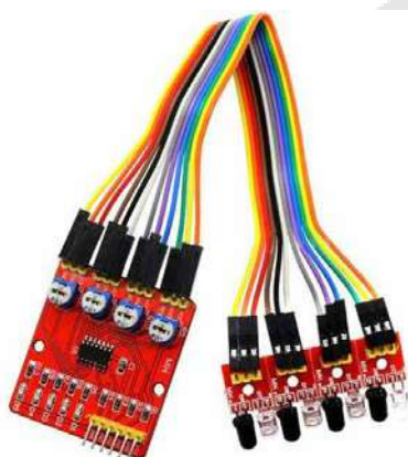
MODULO SENSOR INFRARROJO DE RASTREO DE 4 CANALES.
