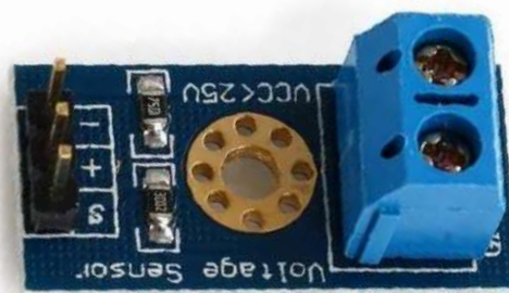
SENSOR DE VOLTAJE 0-25V RANGO DE VOLTAJE: 0-25VCD TAMAÑO: 25MM × 13MM/0.98 "× 0.51"
