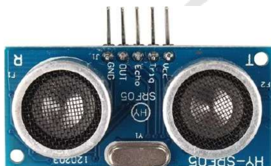
MÓDULO ULTRASONIDO ARDUINO HC-SRF05
