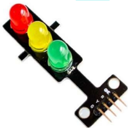
MODULO LED SEMAFORO LUCES CONTROL TRAFICO 5V ARDUINO PIC
