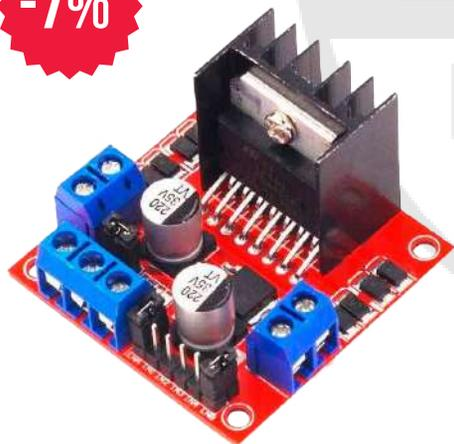
**MÓDULO CONTROLADOR MOTOR L298N -DOBLE PUENTE H**
