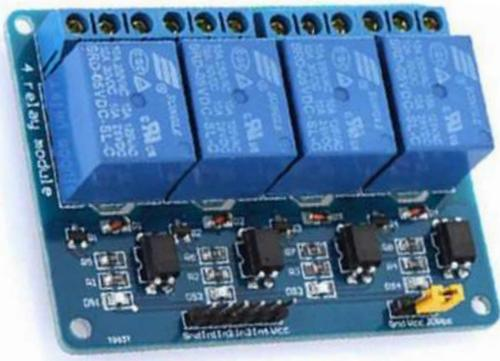
**MÓDULO RELE 4 CANALES ARDUINO**
