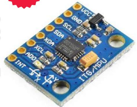
**MÓDULO ACELERÓMETRO CON GIROSCOPIO**
