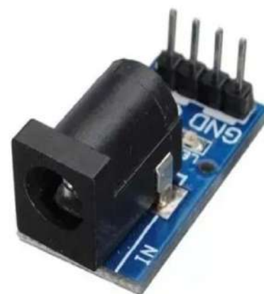
MODULO JACK ALIMENTACIÓN CIRCUITO - ARDUINO
