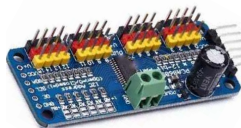
MODULO CONTROLADOR DE MOTOR CON 16 SALIDAS PWM SERVOMOTOR ARDUINO
