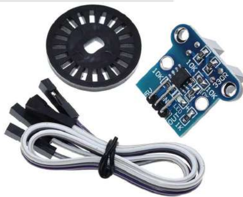
SENSOR VELOCIDAD ENCODER CON RUEDA HC-020K 20PPR
