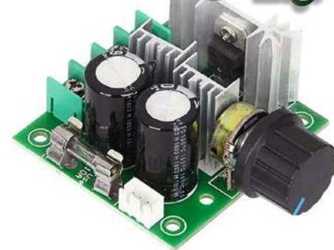
MÓDULO REGULADOR DE MOTOR PWM DC 12V/24V/30V/40V CON INTERRUPTOR DE CONTROL DE VELOCIDAD 10A .
