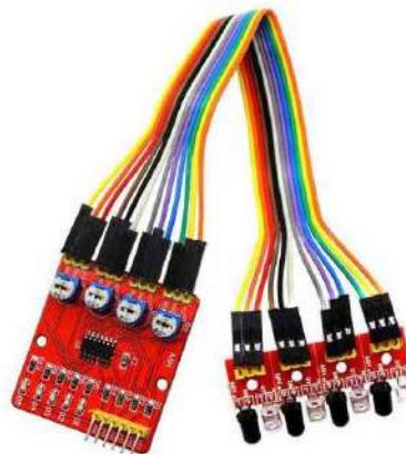
MODULO SENSOR INFRARROJO DE RASTREO DE 4 CANALES.
