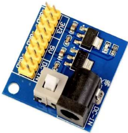
REGULADOR FUENTE PROTOBOARD DUAL 3.3-5V PLUG MODULO ARDUINO
