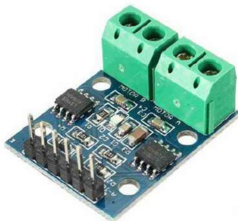
MÓDULO CONTROLADOR PASO A PASO DOBLE
