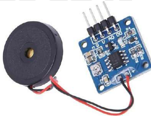
MÓDULO DE SENSOR DE VIBRACIÓN PIEZOELÉCTRICO
