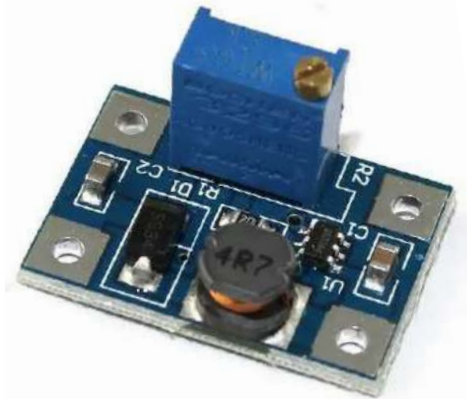
MODULO CONVERTIDOR DC-DC ENTRADA 2 - 24 VOLTIOS SALIDA 5 - 28 VOLTIOS MÁXIMO 2AMP
