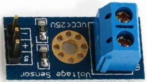
SENSOR DE VOLTAJE 0-25V RANGO DE VOLTAJE: 0-25VCD TAMAÑO: 25MM x 3MM/0.98 "x 0.51"
