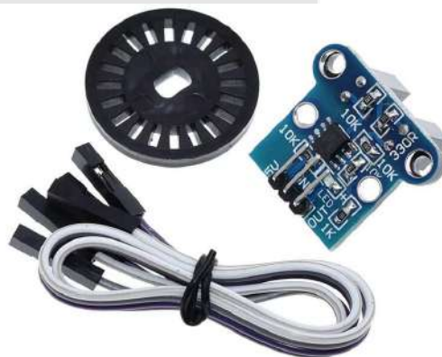
SENSOR VELOCIDAD ENCODER CON RUEDA HC-020K 20PPR
