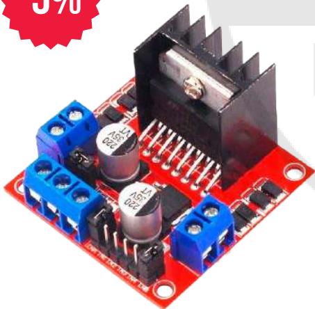
MÓDULO CONTROLADOR MOTOR L298N -DOBLE PUENTE H
