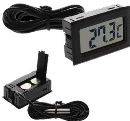
MODULO SENSOR TEMPERATURA
