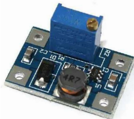
MODULO CONVERTIDOR DC-DC ENTRADA 2 - 24 VOLTIOS SALIDA 5 - 28 VOLTIOS MÁXIMO 2AMP
