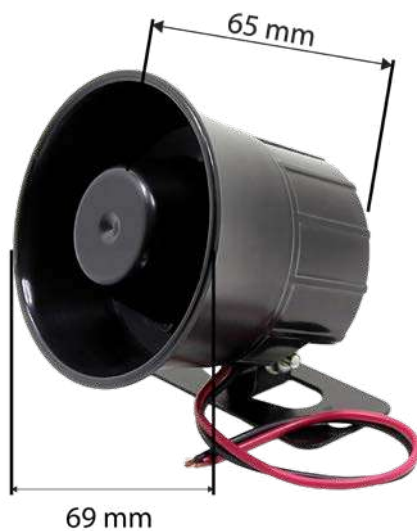
SIRENA DE 1 TONO PARA 6 DC VOLTS DE 15 WATTS. REDONDA DE 2 1/4".
